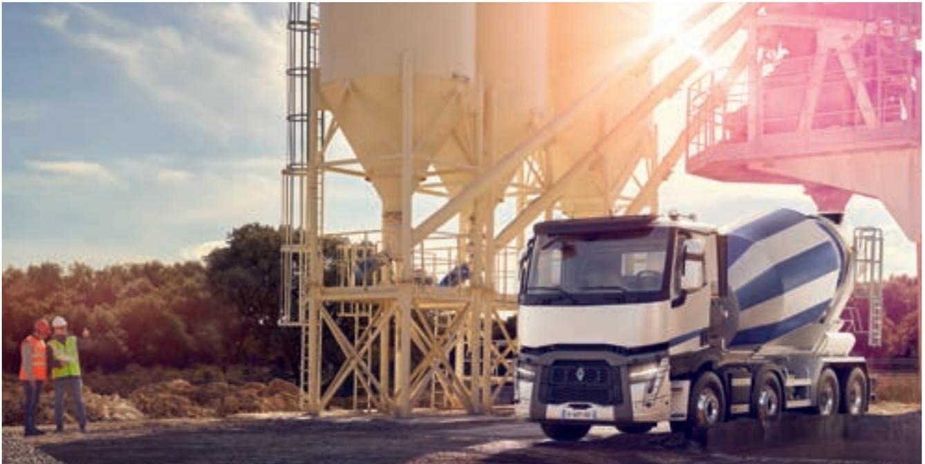
La hormigonera rígida C XLOAD 8x4, con un peso en vacío de 9.200 kg.
